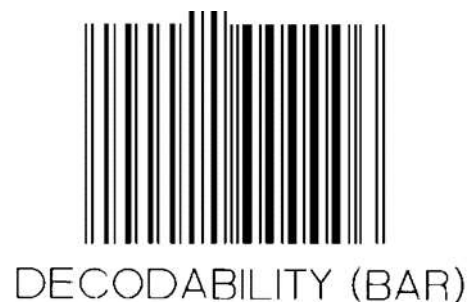
Abbildung 5.12.5.12-3. Symbol zur Kalibrierung mit einer bewusst niedrigen Klassifizierung der Decodierung
