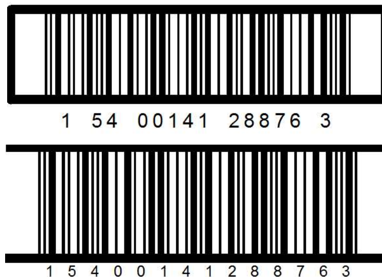
Abbildung 5.3.2.4-1. Beispiele von Trägerbalken
